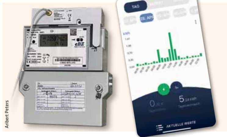
Der Poweropti sitzt auf dem Zähler und wertet die optischen Signale des Zählers aus.
